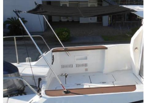
ロッドホルダーを利用してテレスコハンドルをセット、抜け止めと張りをカムクリートで行っています。
