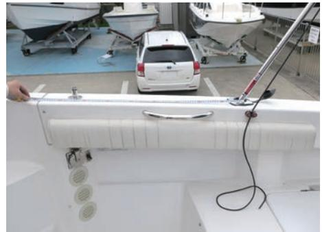
FRP合わせ目から880mmの所に埋め込み型ロッドホルダーを設置。カムクリートも隣に設置。
