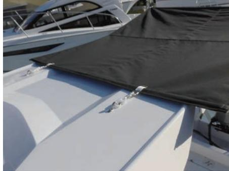
ルーフ後部にアイストラップを設置し、ベルトで補強したオーニングをナスカンで固定しています。
