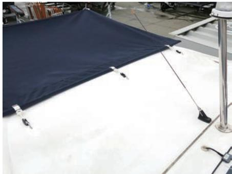
ルーフの上にアイストラップを3カ所付け前方向のオーニングを固定しています。
