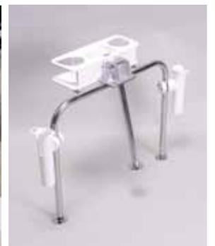
船外機が邪魔でマストをオフセンターにするのは間違いです。スパンカーはセンターに付けないと常に舵が切れている状態になります。スパンカーマストを船のセンターに装着できるようにステンレス製架台で対策しましょう。(※小物入れ付きドリンクホルダーやロッドラックをセットすると便利です。)
