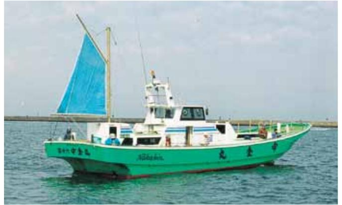
1975年、従来木製や鉄製だったスパンカーの帆柱をヨットのアルミ製マストに変えて作製したのがFMS製スパンカーの始まりです。その軽さ、耐久性、効率の良さは高く評価され、漁業の近代化に大いに貢献しました。元来プロ用に開発した物なので強風にも耐えられる設計の上、その後も最大の効果を得るためにセイルを常にフラットに張っておけるよう構造を追求し続け、改善・改良を加えてきました。今では、20トン未満の船舶全てに安全に適用するサイズ規格を作り、安全対策を施して各艇に合わせて製造しています。
