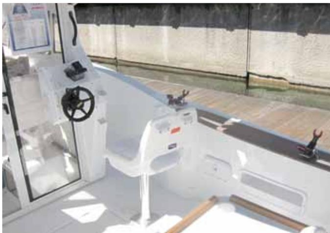
アフトステーションではフィッシングシートに座って手前船頭の釣り座システムを完成させています。大型の生簀ハッチがありますのでこれ以上左舷に寄ることができないのですが、生簀ハッチを毎回開けないで小さなハッチを付けて対応するようにすれば、シートの高さを下げることできます。
