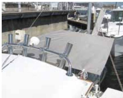
スパンカーを利用して取り外し可能なオーニングを設備しました。幅1.3mで長さ1.44mですが夏の日差しは十分遮る大きさと思います。全速で走行してみましたが強度は十分保たれました。(収納袋付)
