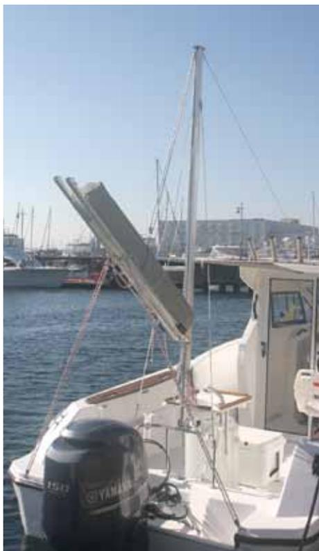
スパンカーはモーターウェル前のセンターに付けているので、展開収納も安全に行えます。マストをオフセンターに付けている船を見かけますが、基準が連れてしまう? ので制御しにくくなると思います。
