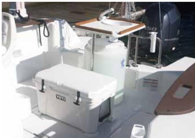
ベイトタンクの容量は53ℓ、テーブルはキングスターボード製でシンクとシャワー兼用フォーセット (スイッチ付) を付けて清水ギャレーシステムを完成。清水の汲み上げはタンクに入れた水中ポンプ (毎分10リットル) で行います。保冷力抜群なYETIクーラーボックスは、後部座席としても利用が可能です。
