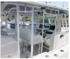
走行性能の高い高速艇だからこそ敢えて硬質な 素材を避けて、ショックを吸収できるビニール 系のスタータグラスとスタモイドを採用。また、 少しでもたわめばバタついてしまうので、出入 策しています。
