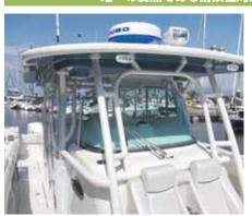
Tトップ自体をエンクロージャーで覆う作業は 弊社が全てを請負って艤装しましたが、最大ス ピードが55ノット、さらに強化ガラス製のフ ロントグラスは覆わない条件付きでした。 強化ガラスとルーフの隙間もビニールで覆いべり口開閉部分にはベルトと締め金具を使って対ることができ、キャビンの中にいるような気分
