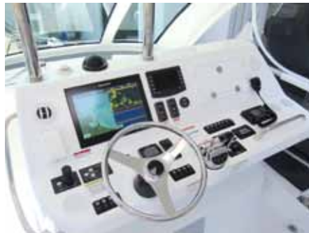
運転席前に gS165 (画面サイズ15.4インチ) を配置。ハンドルの前右側にリモートキーパッド RMK-9、左にオートパイロットコントロールヘッド P70R を配置、また右側には国際VHFトランシーバーアイコムIC-M506Jを装備しました。
