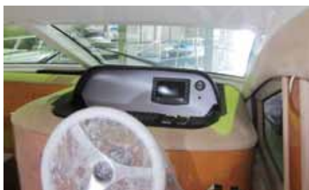
ロアヘルムステーションの右側にトヨタ純正マルチメーターディスプレイが装備されています。正面視界を遮らないように高さが抑えられ大きなディスプレイは選択できませんでした。隣に gS95 (画面サイズ9インチ)、その左側にオートパイロットコントロールヘッド P70R を配置しました。
