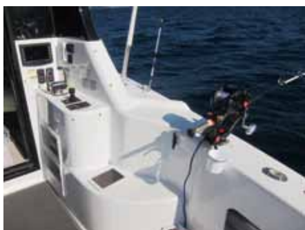
トヨタが誇るTVAS「バーチャルスパンカー・コンパスモード」を使って手前船頭でボトムフィッシングができるようにというご希望から設置したアフトステーション。
