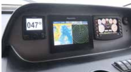
ロアヘルムステーションの右側にトヨタ純正マルチメーターディスプレイが装備されています。正面視界を遮らないように高さが抑えられ大きなディスプレイは選択できませんでした。隣に gS95 (画面サイズ9インチ)、その左側にオートパイロットコントロールヘッド P70R を配置しました。
