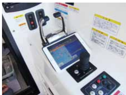
RaymarineナビゲーションシステムはWi-Fi機能内蔵ですのでiPad等のタブレットを活用して手でプロッタや魚探をリモートコントロールすることができます。
