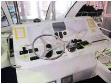
中央にトヨタ純正マルチメーターディスプレイとエンジンスイッチが装備されています。オーナーと詳細な打ち合わせが行われ計画された機装プランに沿って配置場所にマーキング。そしてオーナーに最終確認をしてもらいました。
