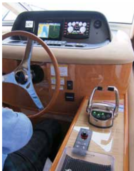
この艇のロアヘルムステーションは運転席に座ってしまうと画面パネルに手が届きません。その為レバーリモコン後部に多機能ディスプレイ用リモートキーパッド RMK-9 を装備しました。(レバーリモコン後部にはスペースがあるのでオートパイロット P70R を配置することも可能です)
