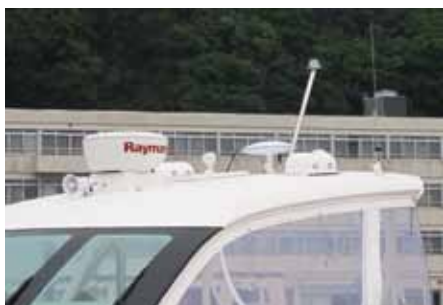
レーダースキャナは18インチ出力4KWのデジタルカラーレーダー、最大距離範囲は48nmと記載されていますが、テスト走行で25マイル先の大島を確認できたので十分な性能と言えます。
