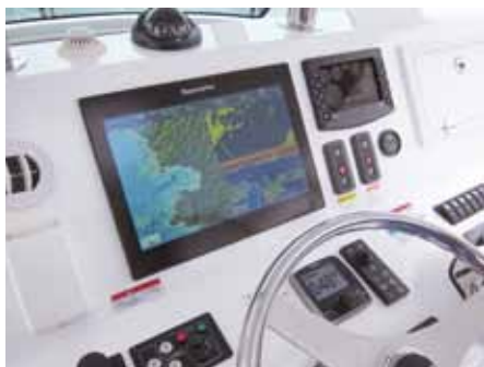
多機能ディスプレイ画面でGPSプロッタ (左)、レーダー (右上)、魚探 (右下) を表示。
