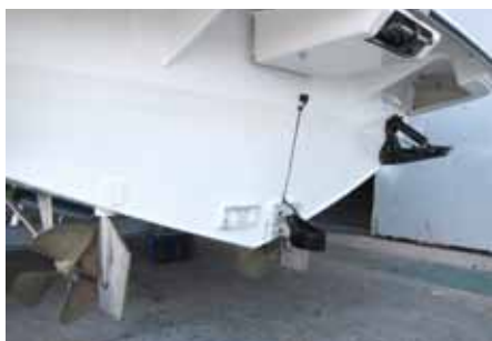
魚探はデジタルソナー1KWでトランサムマウントトランデューサー TM258 を選択。トヨタ艇はアルミ製のため船体に穴を開けないという規定があるため、亜鉛板のボルトを利用して設置しました。
