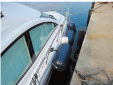
岸壁に係留することを考え用意していったインフレーターファンダー（φ450×680mm、φ450×1060mm各2本）に電動エアポンプで空気を入れて使っています。
