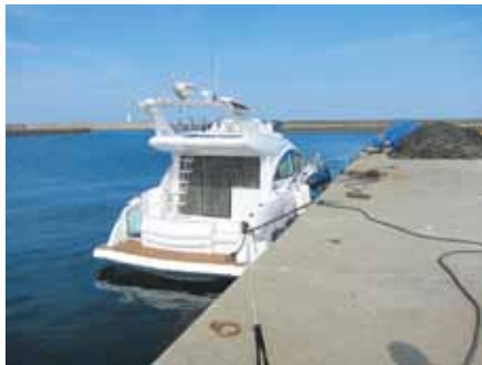
市場に面した東側の岸壁に係留、その日は小潮周りだったので干満の差は50cmなので助かりました。岸壁のコンクリートと擦れる部分にはロープで保護したスレ止め用ワイヤーを使用しました。
