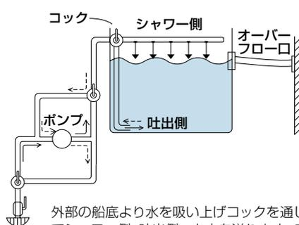
外部の船底より水を吸い上げコックを通してシャワー側、吐出側へと水を送ります。この方法ですと、船底に穴をあけスカッパーを取り付けなくてもイケス内は常にクリーンな状態を保てます。この際、オプションとしてオーバーフロー口を取り付けておかないとイケス内に水があふれてしまいます。
