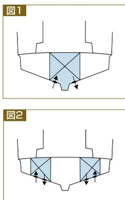
次にイクス内に水を張った場合の船体への影響に関して説明すると、中央部（センターライン上）に単独で作られるイクス（図1）は、水の出入口用スカッパーがとてつもなく大きくないかぎり、水が喫水レベルまでイクス内に入ること、その分KG（ベースラインの下面から船の重心までの高さ）を下げたことと同じような結果になるため、喫水が下がった分だけ船が重くなったといえます。しかし、左右に設けたイクス（図2）内に水が入り、出入口用スカッパーを通して水の出入りがある場合は、復原力に影響し、水の出入りが多い程、復原力を下げてしまうこととなります。したがって、荒海を航海する小型船舶などのイクス設備は中央に配置することが望ましく、複数に設備する必要がある場合には、出入口用スカッパーのサイズをできるかぎり小さくして利用するか、あるいは全く利用しないでポンプにより水を循環させる方法を採用するほうが安全であるといえます。
