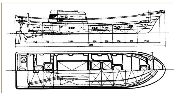
イクスのように水密性を重要とする設備は、船体構造においても十分な強度がある部分を利用して配置する必要があります。そのため通常の漁船では、バルクヘッド（隔壁）間を利用して建造されることが多く、衝撃やねじれなどによって他の区画に水が侵入しないよう十分な工程と技術が必要になります。又、区画内をイクス、倉庫、空所などいくつかのスペースに分けて利用する場合は、さらに工事の完璧さを要求されます。
