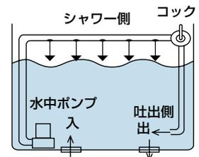
イケス内の水を水中ポンプを利用して循環させる方法です。船底にスカッパーがあれば外からの水も取り入れることができます。エンピ管などを利用してイケスの高い部分よりシャワーを吐出させる場合、シャワーエンド側にコックを取り付け、さらに吐出用のエンピ管を追加することによって、コックの開閉でシャワー側、吐出側の水量を調整することができます。
