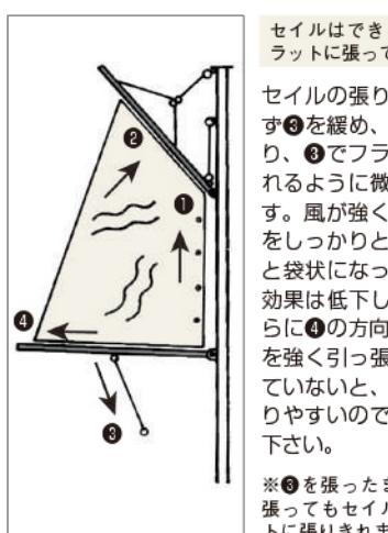
セイルの張り方は、まず③を緩め、①②を張り、③でフラットに張れるように微調整します。風が強くなると①をしっかりと張らないと袋状になってしまい効果は低下します。さらに④の方向にセイルを強く引っ張り、止めていないと、しわになりやすいので注意して下さい。
