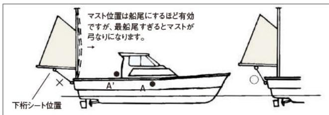
スパンカーを取り付ける目的は、水面上船体の面積中心A点をできるかぎり船尾方向に移すことであるため、マストはできるだけ船尾近くに取り付けた方がより大きい効果が得られることになります。しかし、あまり船尾に近すぎると、展開時、収納時の作業効率が悪いばかりでなく、下桁シートの船体取り付け部との角度がきつくなるため、マストを押す力が増してマストが弓なりにペントしてセイルがフラットに張れなくなります。従ってマストは使用時の作業スペースやサイドステーなどの位置関係も考慮に入れた上で、できるだけ船尾近くに取り付けるのがベストなのです。
