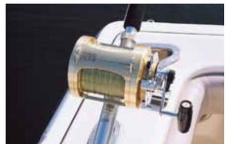
※ストライク時のドラッグ強度をリール側で設定したら、さらにその強度の2/3、1/3とドラッグ強度を計測して、このポジションをリールにマークしておくとう便利です。対象魚やファイトのやり取りなどで微妙なドラッグ調整が効果的に活用できます。
