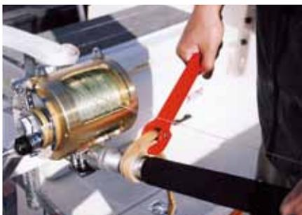
ライトクラスのセッティングなら手で確実に締め込み、リール側に付いているロッドクランプで固定すれば安全なのですが、50ポンドクラス以上のリールをセットする場合、ストラップレンチを利用してバットやリールシートのリングを締め付けることが必要です。ファイト中、リールが左右にガタガタすると、とても使いづらくハンドル操作がうまくいきません。
