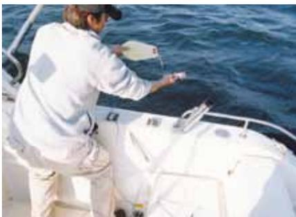
潜水板が最も効果的に潜る長さ(船体から潜水板までの距離)を決定し、船体のクリートやアイに道糸を固定します。次に足元からむことなくスムーズに糸が出るよう整理して、潜水板を投入します。この時、板が上に向かないよう投入しますが、途中で上に向いてしまい、ヒコーキのように飛び跳ねてしまったら、少し道糸をたぐりよせ、裏返す動作を加え、潜ったら素早く手をは
