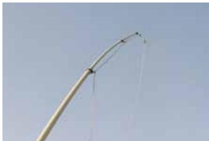
曳釣りに使用するFRP製アウトリガー・ポールは、ねばりとしなやかさがある釣竿と違い、強度と弾力性に富むもので、直接魚を掛けてぶらさげってしまう曳釣りでは魚が掛かった時のショックで魚の口切れを起こしてしまう危険性があります。そのため曳釣りではアウトリガー・ポールの先端にハイパワーコードを付けることを基本としています。
