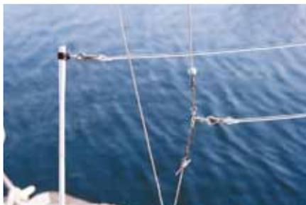
曳釣り用ポールラインのアウトリガー・ポールへの接続方法は、曳釣りしか行わないタイプの方にお勧めなポール先端に直接付けるシンプルな方法と、トローリング用ハリヤードラインシステムのトローリング・クリップと入れ替えて、フタバ親子サルカンを利用して接続する方法があります。目的に応じて使い分けると便利です。
