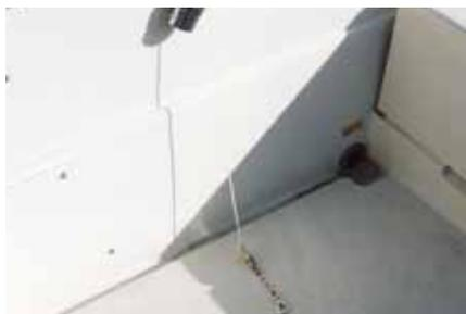
アウトリガー・ポール先端に曳釣り用ポールラインを接続したら次は船体側の調整です。アウトリガーを展開し、内舷デッキ下に鉛付きサルカン又はナスカンが余裕をもって付く所でラインを調整します。このことは魚が掛かり道条をたぐりよせている時、風や船の揺れでラインが船外に出ることを防ぐ役割をさせています。
