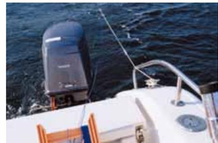
ヒコーキ、潜水板、ツバメ板、ビシヤマ等の道具を船体から直接曳く場合は、ハイパワーコードを船体側に使用することは基本です。上の写真のようにハイパワーコードにロープを付け、ロープ部分を船体側のクリートやアイに縛り調整することで、ハイパワーコードは船体に触れることなく100%の能力を発揮します。
