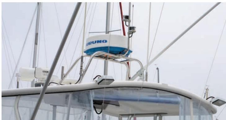
ブラックウォッチ40のルーフトップに、センターリガーをFRPボールA-1と組み合わせて装備しています。この船は主にトローリングですが、FRPの弾力によるたでの動きを少しでもルアーに与えられるようFRPボールを選び、角度も少し立ててセッティングしています。
