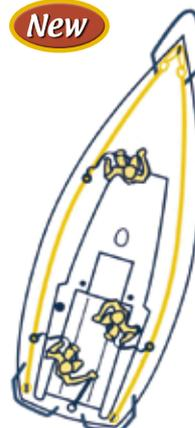
デッキにセットするUV対策された平ベルトタイプのライフラインです。両端に30cmのアイがあるのが特徴で3000lb (2727kg) の強度があります。
