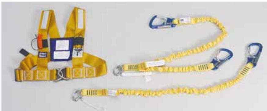
このハーネスの最大の特徴は、ISAF（国際セイリング協会）が要求する強度を満たし、より容易に着用できるように幅50mmの柔らかいベルトにDリングとアセタール樹脂のバックルで作られている点です。
