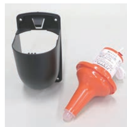
●自己点火灯 KM79S 型式承認番号NO.5632 サイズ：φ100×195mm 重量：235g (電池含む) 発光時間：2時間以上 光度：2cd以上
