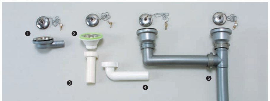
①排水金具 (横抜き) フタ付、内径25mmホース用 ②排水金具 (ドレン部) ネジ部 1 1/4" ③排水パイプ (ストレート) 内径32mmホース用 ④排水パイプ (エルボー) 内径32mmホース用 ⑤排水金具ダブルシンク用 ドレン間の芯々のピッチが32cmまで取り付け可能です。内径38mmホース用
