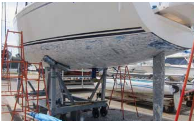
気が遠くなるような作業でしたが、毒性のある塗装部分はほぼ剥がすことができました。舵やキールの部分も完璧に落としていきます。
