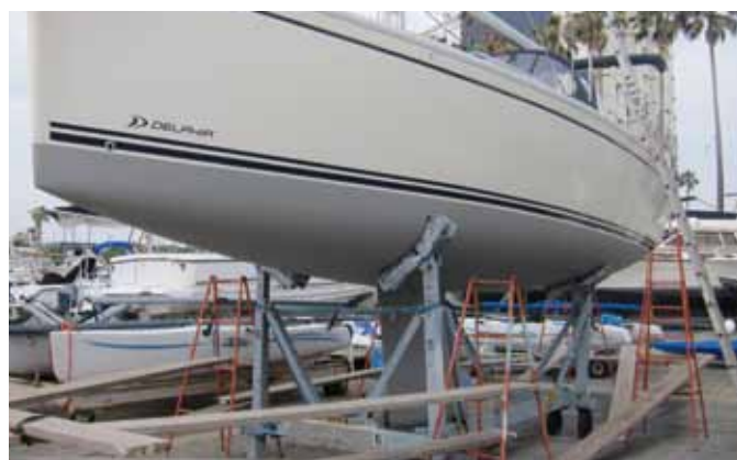
船体部は013 FRP用エポキシプライマー2回塗装し015バインダーを1回塗装。そして039船底塗料を2回塗装、喫水付近はさらにもう一度塗装しています。塗装間の乾燥時間を十分にとり完璧な塗装作業でした。
