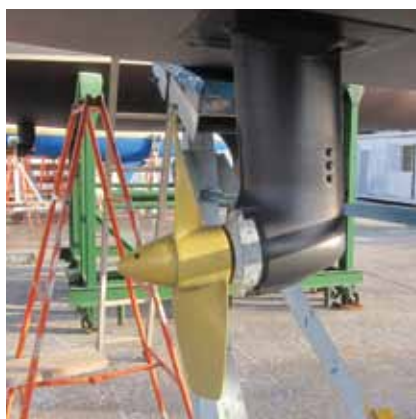
セイルドライブは通常の船底塗装。プロペラ部はペラクリンセットで上塗り3回塗装。ペラクリンは取扱説明書通りに施工する事、特に乾燥時間厳守は最重要です。
