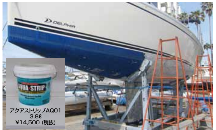
喫水より上の部分は塗装が硬いのでスクレッパーだけでは剥がせません。ペイントリムーバー（アクアストリップAQ01）を使っていました。
