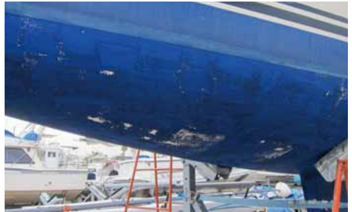
この上から塗装してしまうと船底はボコボコになってしまいますし、すぐに剥がれる可能性がありヨットにとっては致命的です。
