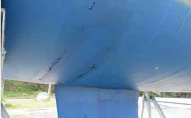
船体が乾き始めるとバリバリと船底塗装部分が剥がれてきました。特に以前に船台やベルトがかかった部分はひどい状態です。
